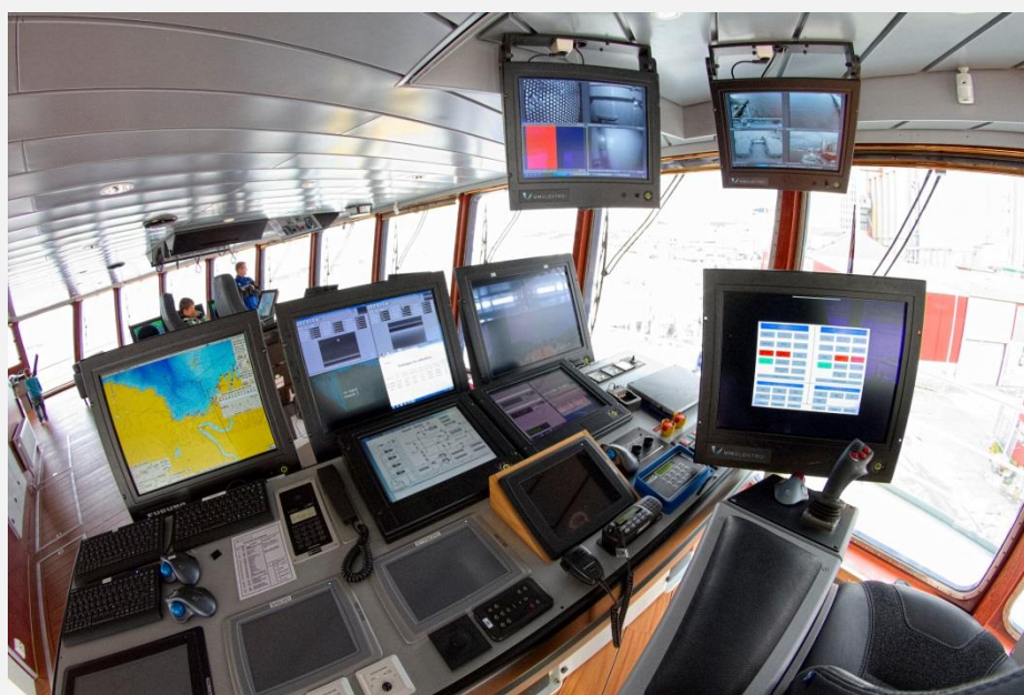
Figur 13: Operatørstasjon for fiskehåndtering på nyere brønnbåt (Foto: SINTEF Fiskeri og havbruk).
