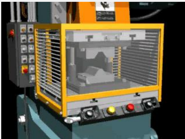
Figur 2. Fysiske barrierer som gjør at fingre ikke kan komme inn i farlig sone (illustrasjon: www.safetytrainingservices.net ).
