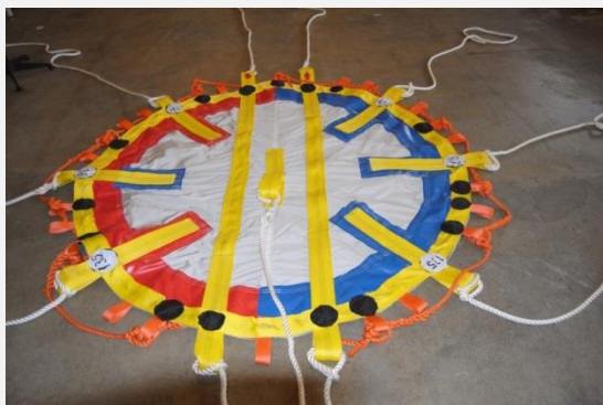
Figur 7. Modell av en heldukspresenning med fargekoder på områder og trekklinjer (foto: Botngaard)
